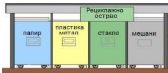
Слика 14.1.1. Предлог организационе шеме надземног рециклажног острва(ТИП 1)
