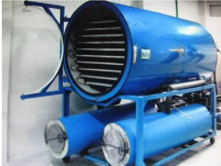
Слика 3.7-Уређај за лиофилизацију
